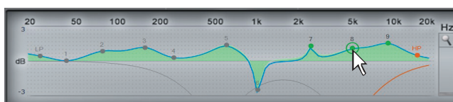
В крайнем нижнем положении ползунка шкала отображает изменения в диапазоне \pm 3 дБ
